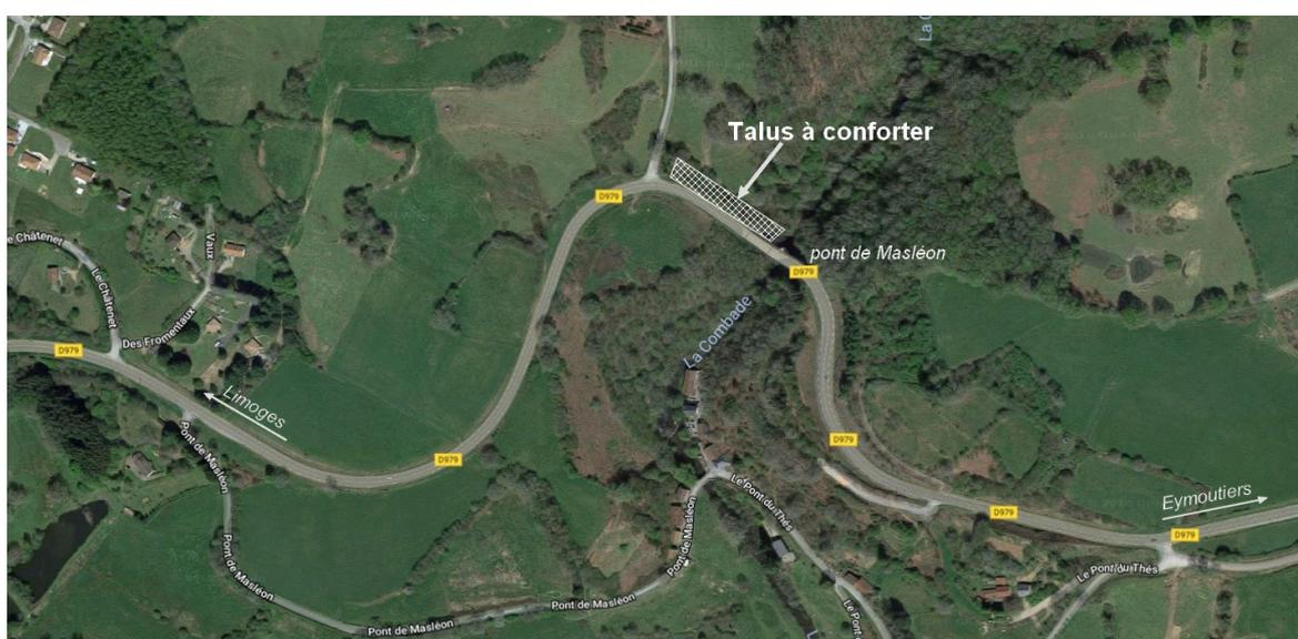
En raison de la configuration des lieux (sortie de virage en bas d'une descente à 8 % et dénivelé de 20 m avec une pente à 80 % au plus haut du talus), un dispositif de retenue de type glissière béton (GBA) est implanté en crête de talus à moins d'un mètre du bord de chaussée.
